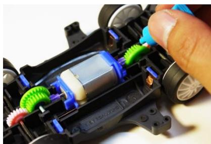
由於連接摩打的齒輪數目較少，利用齒數少的齒輪連接齒數多的齒輪，從而產生較大的推動力。
