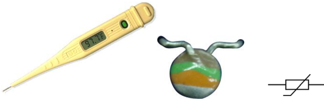
圖5 (a) 電子溫度計 (b) 熱敏電阻 (c) 熱敏電阻電路符號
