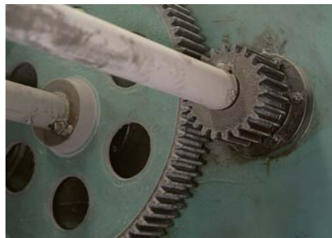
(b) 金工車床中的正齒輪
