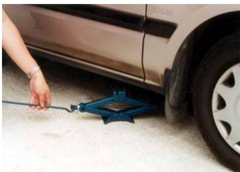
圖1 (a) 增加力的機械(千斤頂)
