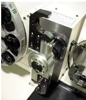
圖10 裝卸機床刀具機械臂
